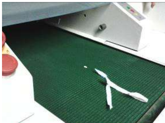
图 2：特制防滑输送带入纸口
